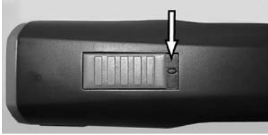
Fig. 4 Brytare i läge FRÅN ("0")
